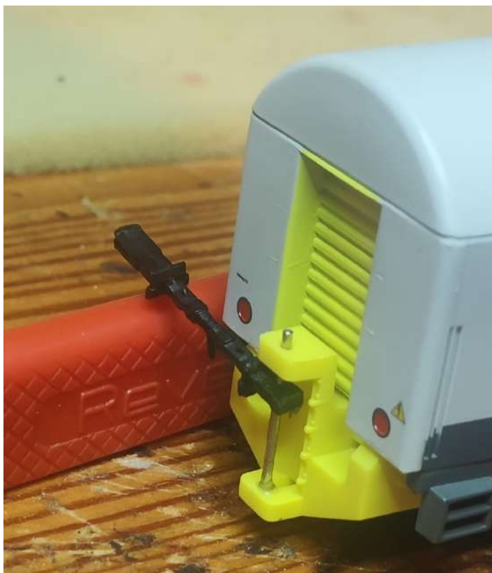
La barre d'attelage maison fixée sur la voiture Rail Adventure avec l'embout Nem à l'autre extrémité.
