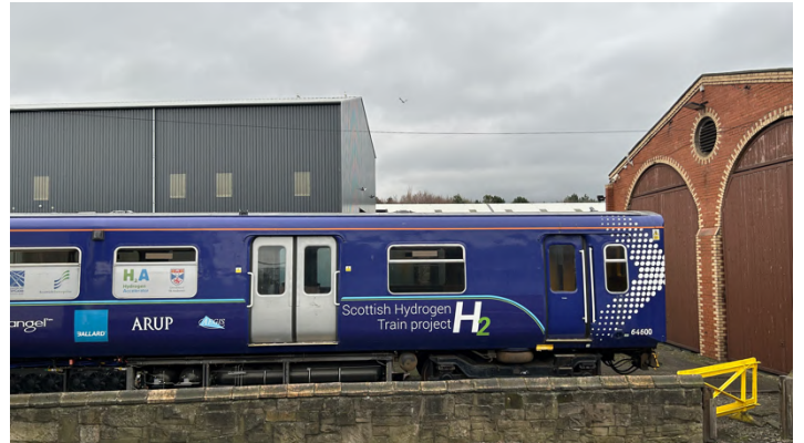
Un élément de rame Class 314 transformée en prototype à propulsion hydrogène/électrique.
