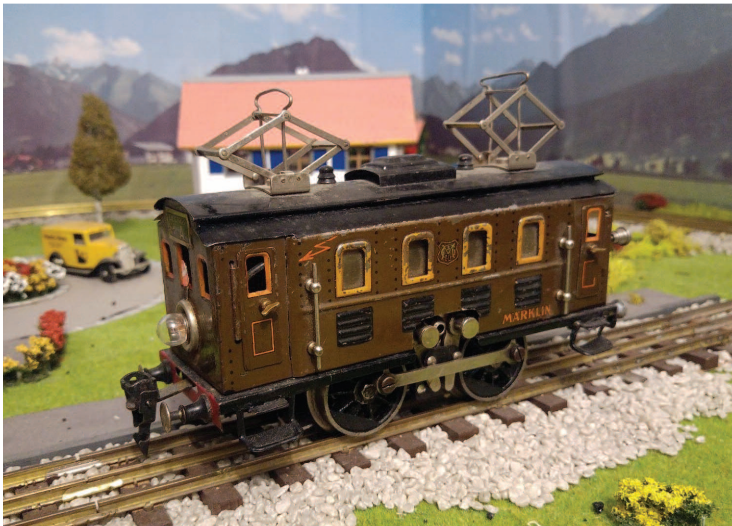
Ma plus ancienne locomotive, la RS 65/13050 de MÄRKLIN, produite de 1928 à 1931. Les contrepoids en carton noir en forme de demi-lune sur les roues sont bien visibles
