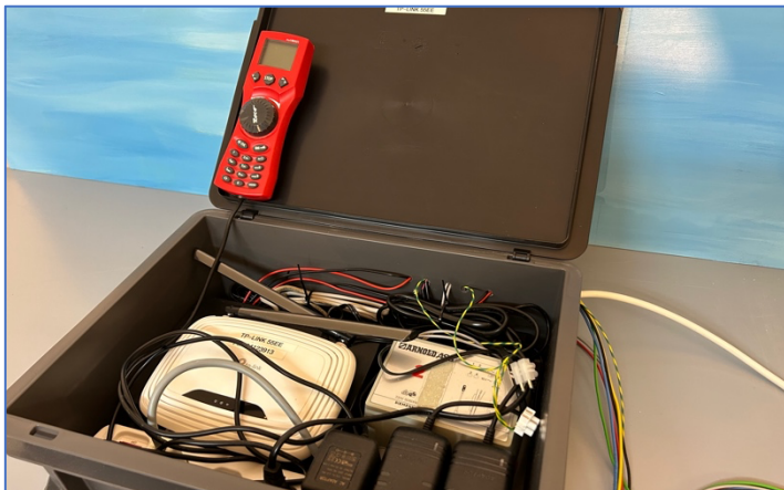
Le coffret d'alimentation : Z21, Wi-Fi, alimentation 16V alt., +12v / 0V / -12 V, MultiMaus, tout compris !
