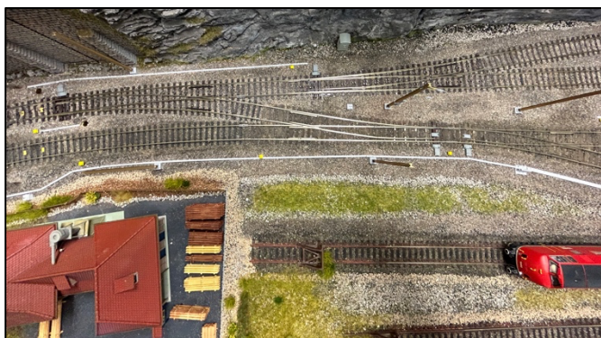
Deux aiguilles modifiées, celle de gauche ne permet pas la déviation en 3r, la suivante est équipée pour les deux directions.
