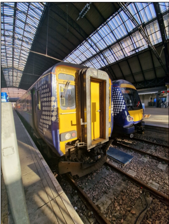
Rames avec poste de conduite intégré à côté du passage d'intercirculation.
