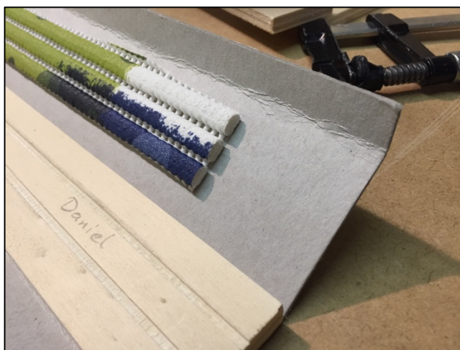
Épaisseur 10 mm, largeur 44 mm, 2 rainures de 2x2 mm
