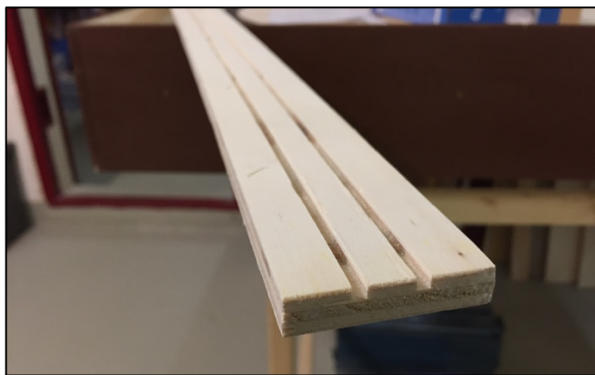
Épaisseur 10 mm, largeur 44 mm, 2 rainures de 2x2 mm
