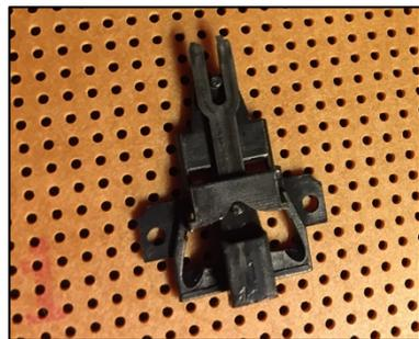
Je perce le plastique du châssis à 1,5 mm et la vis auto taraude le filet sans problème. Avec un châssis métallique il faut naturellement percer et tarauder ce qui est un peu plus long mais pas difficile. Il existe deux modèles différents chez Roco,
