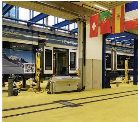
← Capteur laser pour le contrôle des roues.
